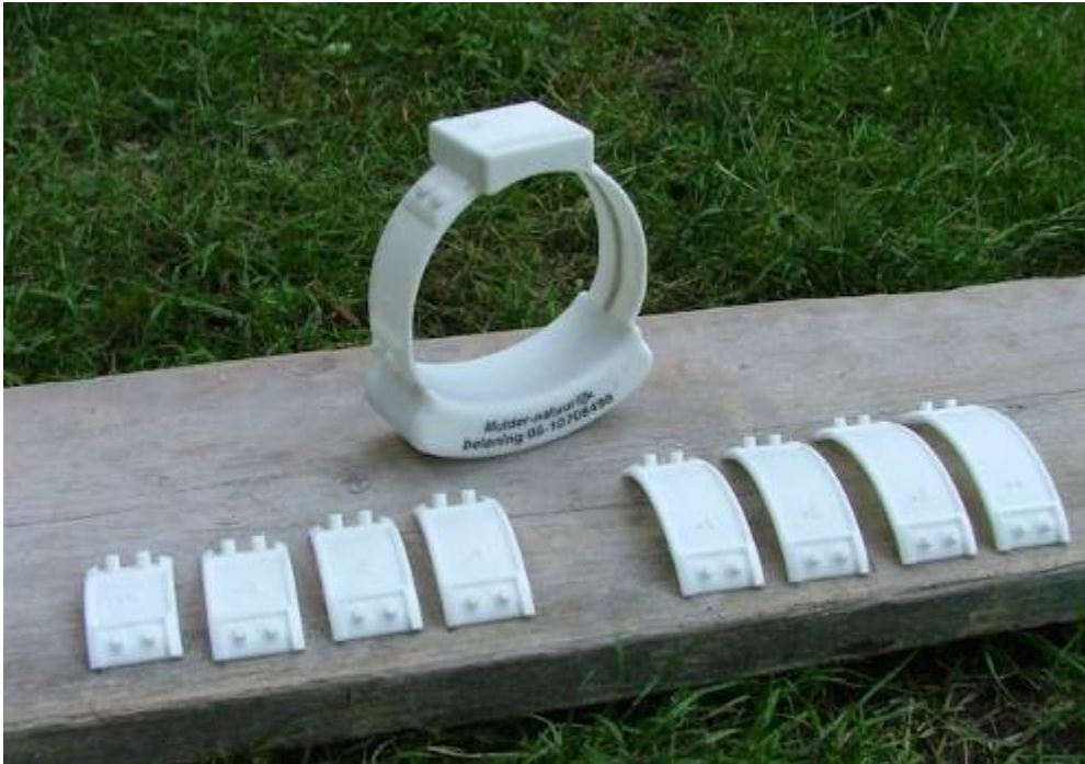
Figuur 3-1 Een GPS-halsband gemaakt met een 3D-printer. De gemiddelde omtrek bedraagt 28 cm; door een keuze te maken uit de bijbehorende serie tussenstukjes, kon de halsband tot op een halve centimeter op maat gemaakt worden
